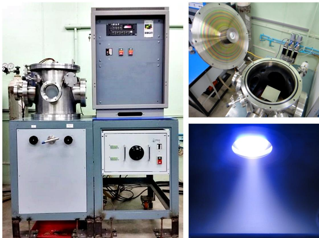
รูปที่ 1 เครื่องเคลือบในสุญญากาศ การติดตั้งคาโทดและพลาสมาจากคาโทดขณะเคลือบ
