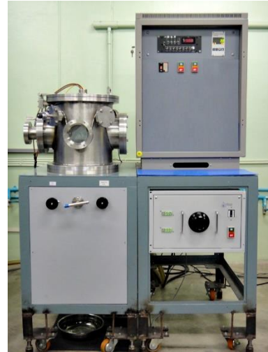
รูปที่ 1 โดอะแกรมและลักษณะของเครื่องเคลือบในสุญญากาศในงานวิจัย
